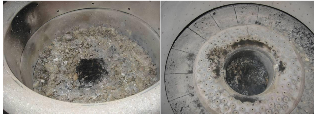
À gauche : brûleur avec résidus et pierres À droite : brûleur à plaquettes sans résidus. I. López
